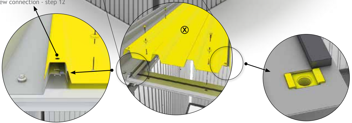
Verschraubung - Schritt 12 screw connection - step 12
